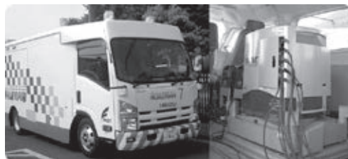
左：ロードマン（路面性状計測量） 右：DMC-C208（デジタル航空カメラ）
