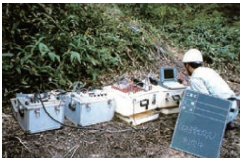
図15 電気探査(全地連HP参考写真集P8)
