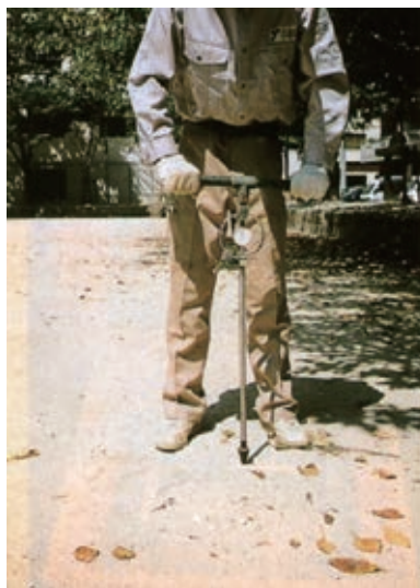
図17 ポータブルコーン貫入試験(全地連HP参考写真集P11)
