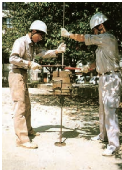
図16 スウェーデン式サウンディング(全地連HP参考写真集P11)
