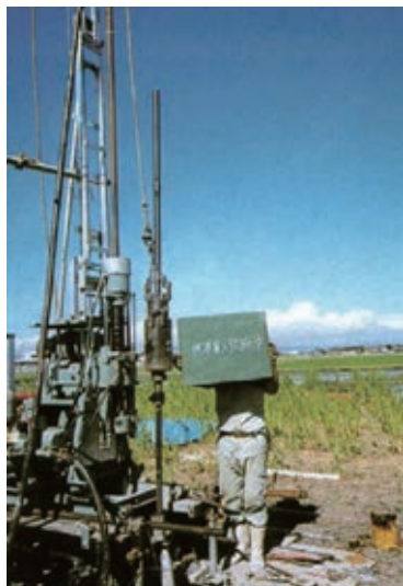
図19 標準貫入試験 (全地連HP参考写真集P10)
