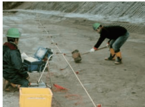
図14 簡易弾性波探査（テクノ長谷HP）
