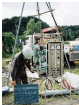
図20 孔内水平載荷試験 (テクノ長谷HP)
