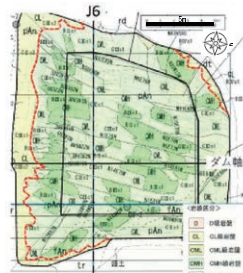
図-4 トレンチにおける比較検討結果(左上:RGBオルソ画像、右上:Red/Greenの反射強度比スペクトルカラーマップ、下中央:地質技術者による岩級区分図) 2)
