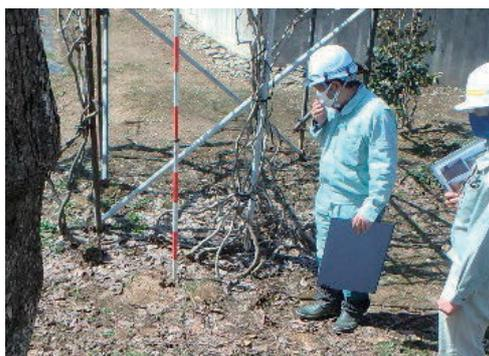
写真-2 漏水箇所③噴砂跡
