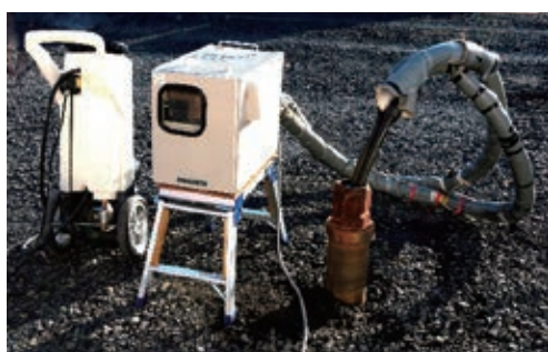
写真-1 TRT 測定状況
