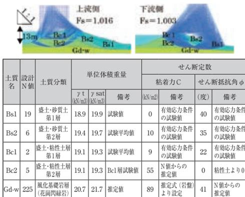
図-4 見直し後の地盤定数とレベル1安定計算結果
