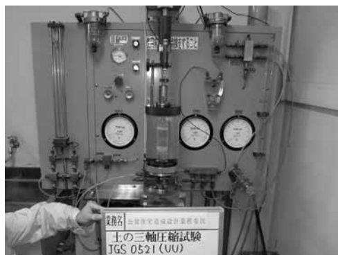
三軸圧縮試験器
