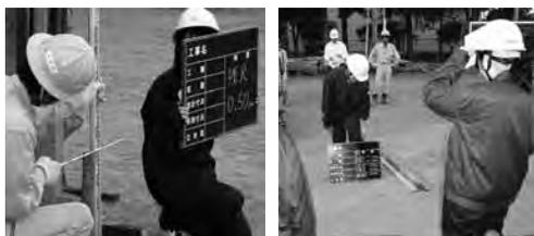
表面波探査は、同じくグラウンドにて、仕組み、原理、測定方法等を説明した後、生徒に受振器を1m間隔に地面に刺してもらい、テイクアウトケーブルに接続してもらって測線を設定しました。
