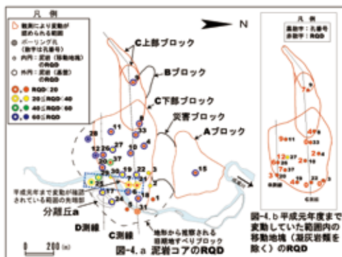
図-4 谷地地すべり地の移動土塊と基盤岩のRQD
