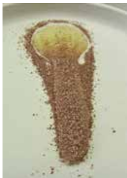
写真4 コンデンスミルク溶岩。この実験では顆粒状のミルクココアを使用している。
