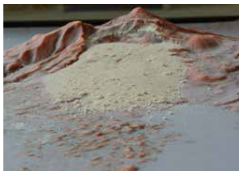
写真10 珪砂による流山実験。多数の「流山」が形成されている。3Dの赤色立体地形図上で実験を行った。立体モデルはアジア航測作成。
