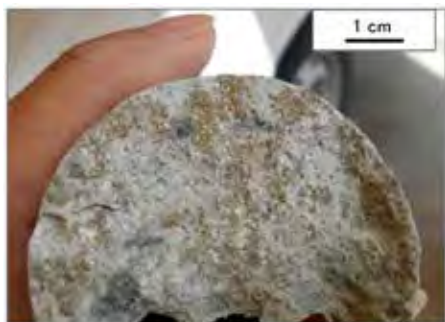
図-2 黄鉄鉱晶出状況 黄鉄鉱の特徴である金属光沢が見られる
