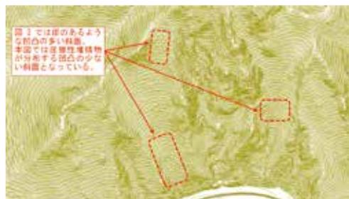
図4 航空レーザ測量による等高線図
