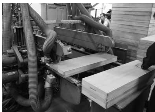
コア箱の蓋の切断工程
