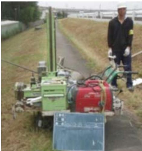
写真-1 河川堤防での SDS 試験の状況
