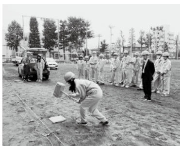
起震（カケヤ打ち）状況
