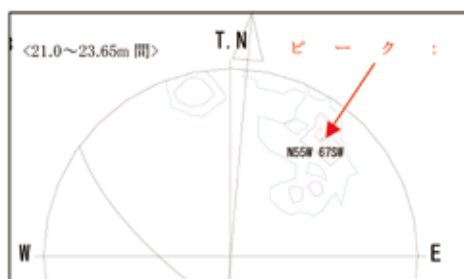
図-5 シュミットネットによる走向傾斜の推定
