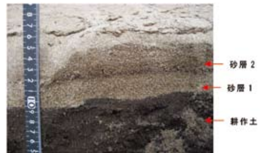
写真-6 粘土層を伴わない砂層 砂層1は塑上時に堆積、砂層2は引潮時に堆積 (図-1の地点5での産状)
