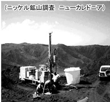
ワイヤーライン工法用削孔機
