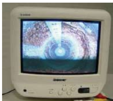
ボアホールカメラ撮影状況 (孔内前方撮影)
