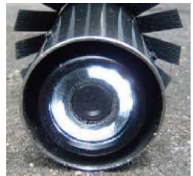
ボアホールカメラ本体 (総重量 7kg、電源 DC12V< 単三乾電池 8 本 >)
