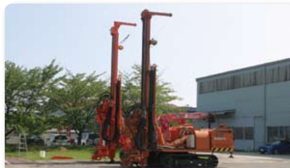
100mの井戸を最短6時間で掘削した記録を持つ最新鋭高速掘削機「ソニックドリル SD-150」
