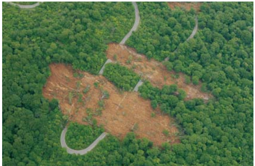
栗駒ダム上流イソカガミ平に 至る道路を寸断した表層崩壊
