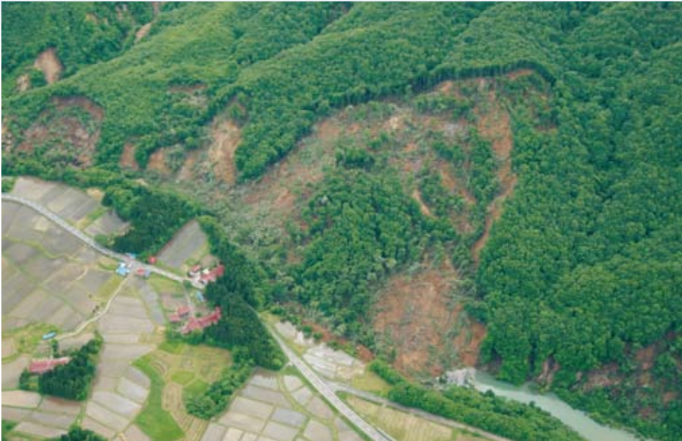
栗駒ダム上流イソカガミ平に 至る道路を寸断した表層崩壊
