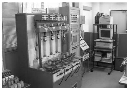
全自動4連式三軸圧縮試験装置
