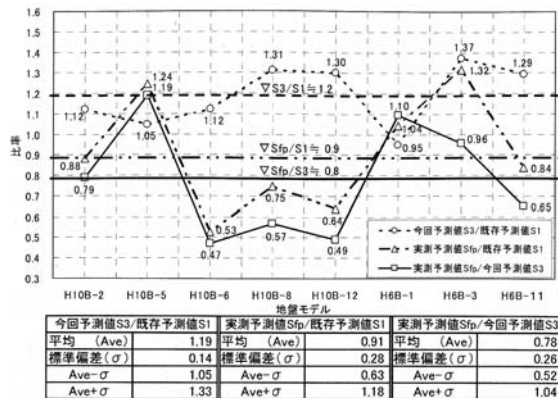
図-4 実測沈下量Sfpと予測値 (S1、S2) との比較
