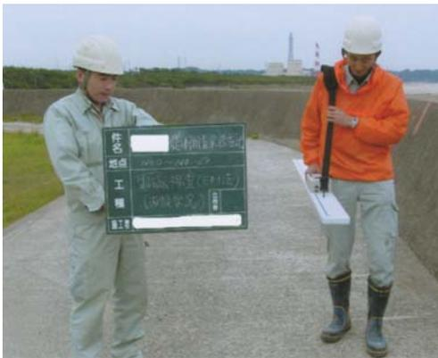
図3-5 マルチ周波数電磁探査 (EM) の測定状況
