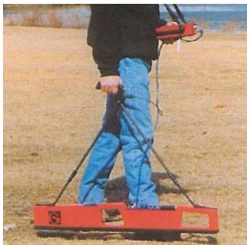
図3-4 EM装置の一例 (Geonics社製EM-38)
