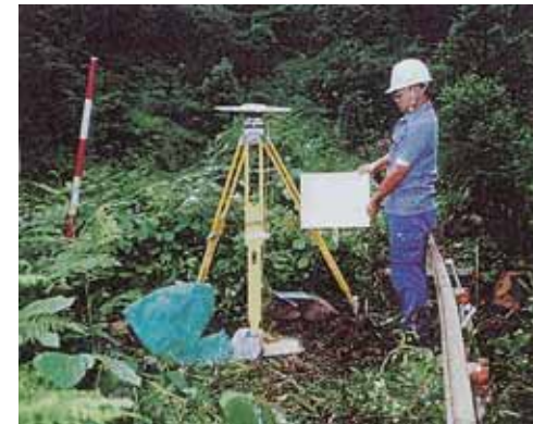
写真2 地すべりでのGPSによる移動杭測量
