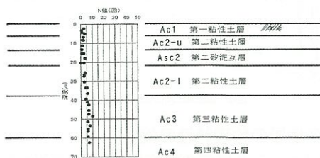
図-1 地質断面模式図
