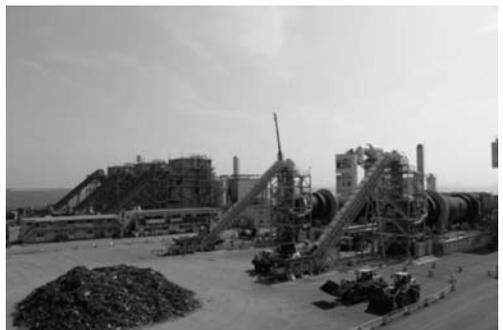
写真-2 手前 焼却炉(ロータリーキルン 処理能力300t/日、2基)
