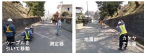
写真-1 表面波探査測定状況
