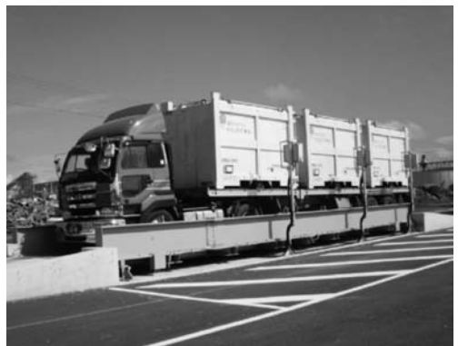
写真-4 空間線量率高速計測システムを設置した搬出ゲート
