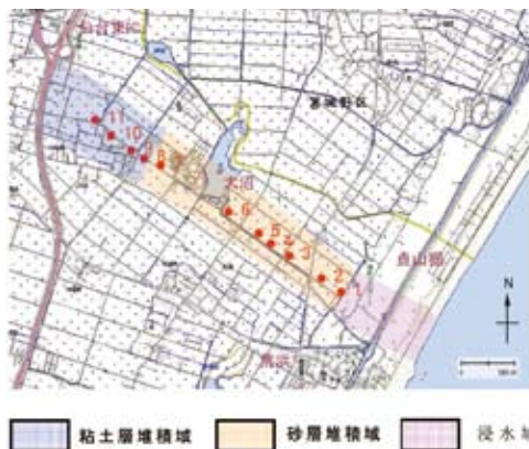
図-3 津波遡上域の堆積物による区分 (仙台市若林区荒浜地区)
