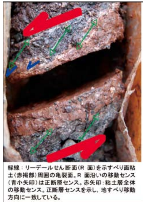
図-2 すべり面粘土の微細剪断構造の事例（拡大写真）
