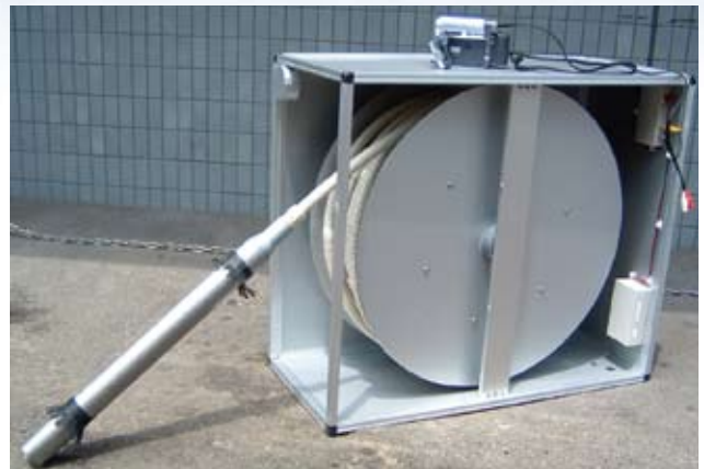
ボアホールカメラ本体 (総重量 7kg、電源 DC12V<単三乾電池 8 本>)
