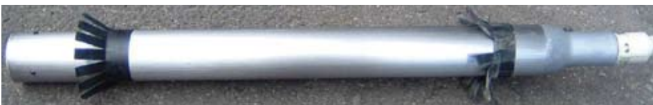
ボアホールゾンデ全体(φ 50mm × L=60cm、ステンレス鋼管)
